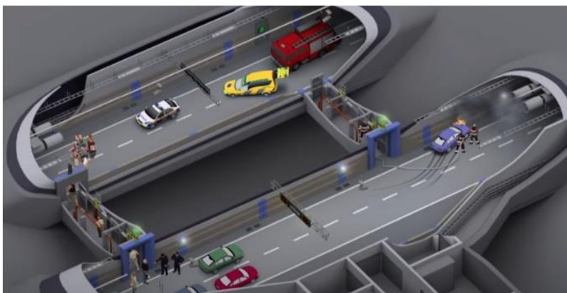
Figur 2. Exempel på insats via det friska röret. Från Trafikverkets informationsfilm Säkerhet i vägtunnlar [28].
