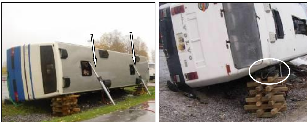
Figur 8.6. Med hjälp av två hydraulcylindrar som placeras i var sitt hörn av takluckan kan man snabbt och stabilt lyfta en buss med stålkaross. Effektiv pallning är nödvändig för att öka säkerheten om strukturen ändå skulle kollapsa. Bilden till höger visar hur pallningen kan se ut, med kilformade ”cribbingblocks®” (inringat) överst för att få en god passning mot karossen.
