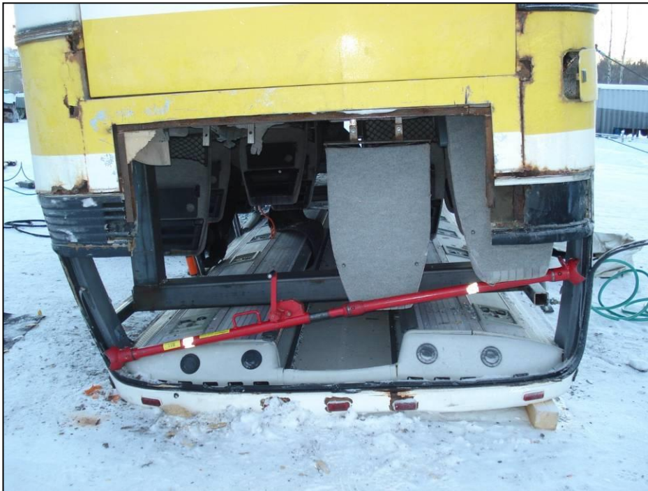
Figur 9.6. Om man avser att rulla över bussen på sidan är det klokt att stabilisera bakpartiet med ett diagonalstag för att begränsa risken för kollaps och sidoförskjutning.
