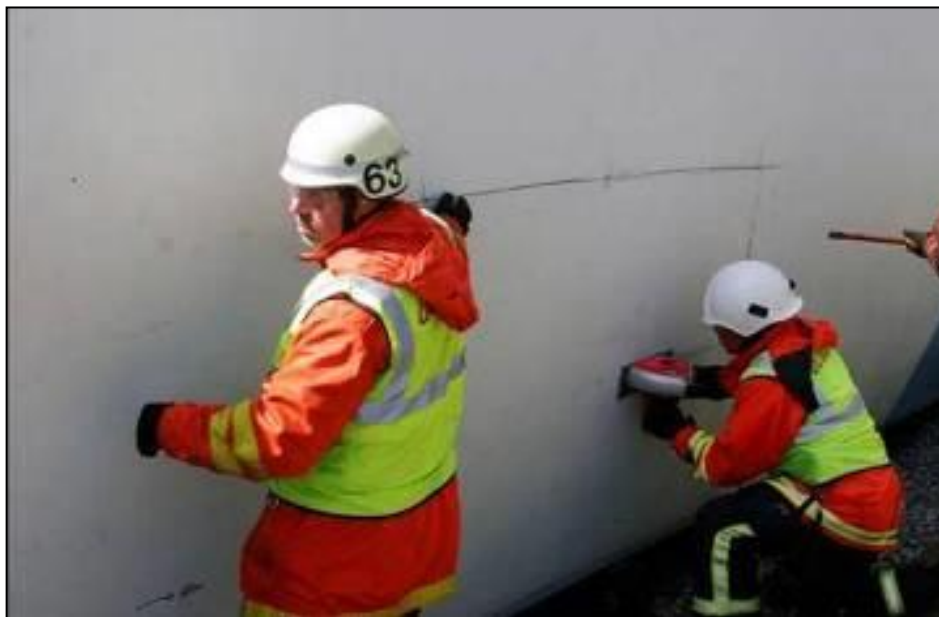
Figur 8.5. Räddningspersonalen rekommenderas att såga upp ett hål i busstaket. Med hjälp av en cirkelsåg tar det två minuter att ta upp en öppning så att personalen får tillträde och de skadade i centrala delen av bussen smidigt kan evakueras.
