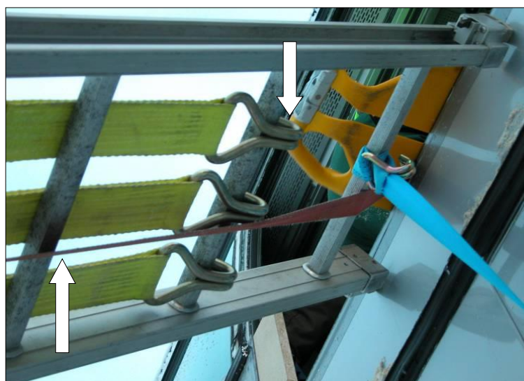
Figur 10.7. Spännband som anläggs underifrån runt stegen för säker evakuering. Notera hur krokarna fästs underifrån medan spännbandet för övrigt ligger ovan stegpinnarna (se pilarna i bilden).
