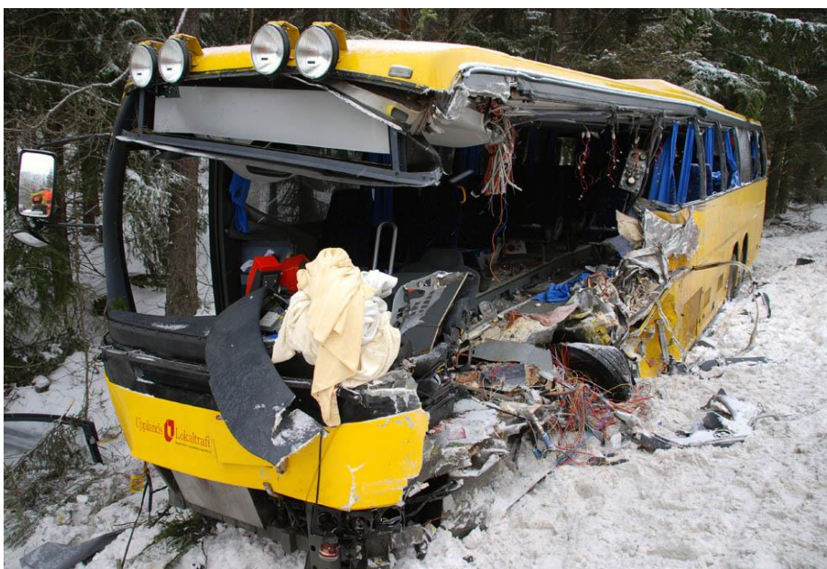
Figur 1.5. Kollision mellan två likadana bussar Uppsala, 2007, 6 omkomna. Samtliga omkomna satt i det område som deformerades vid inträngningen av den mötande bussen. Notera framhjulets vridning 90 grader som indikerar krockkraften – bägge bussarna hade cirka 90 km/t.
