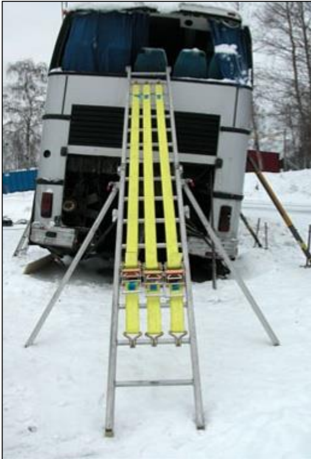
Figur 7.10. Användning av två ihopkopplade stegar vid evakuering. Tre breda spännband håller ihop stegarna och dessa ger också en bra glidyta för bårar och drabbade. I detta fall visas hur uppställningen kan se ut vid evakuering genom bakrutan.
