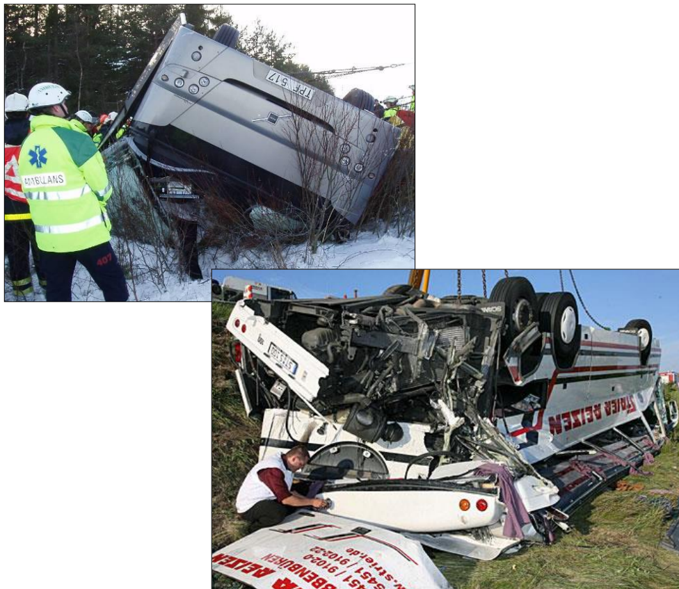
Bild 9.1. Taket trycks ofta ner och förskjuts i sidled när en buss utsätts för en 180 graders roll-over krasch som bilderna illustrerar. Översta bilden är från Arboga-kraschen och nedersta från den tyska kraschen.
