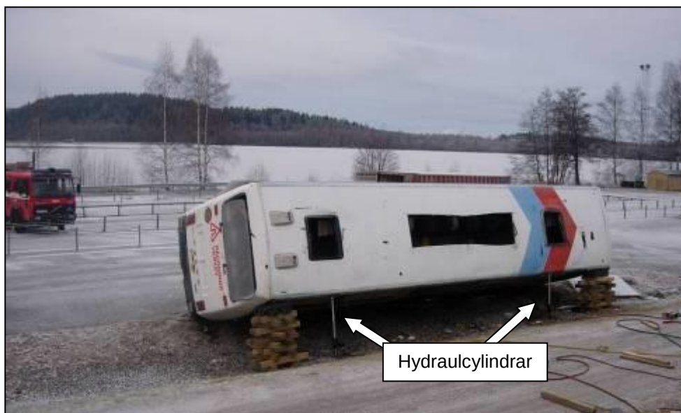
Figur 8.12. Lyftet slutfört med hydraulcylindrar med lång lyfthöjd och lyftet är säkrat med pallningsvirke fram och bak.
