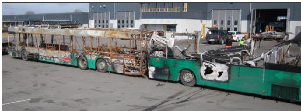
Figur 12.4. De två utbrunna bussarna. MAN-bussen till vänster hade stålkaross, medan Volvo-bussen (till höger) hade kaross av aluminium som till stor del smälte ner vid branden. Kraschen utgjordes av en sk. "full overlap" träff, hörna till hörna. Fronten på Volvobussen trycktes in 16 cm mot bakdelen av MAN - bussen. (Bild ur rapport från SHK, 2013)
