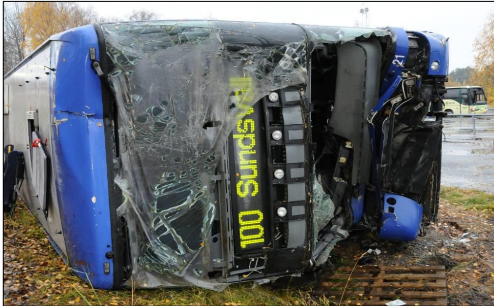
Figur 10.11. Det är statistiskt stor chans att bussen har hamnat med höger sida neråt varvid dörrarna blockerats.
