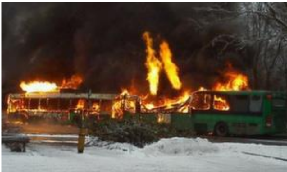
Figur 12.2. Bilden visar de övertända bussarna innan räddningstjänstens ankomst. Notera lågorna (jetflammorna) från gastuberna som är riktade uppåt i detta fall (Bild ur rapport från Statens haverikommission, 2013).
