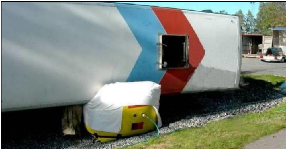
Figur 8.14. Lyft med en lyftkudde placerad i höjd med bussens tyngdpunkt. I detta fall lyfts en buss med mittmonterad motor och stålkaross. Det är viktigt att stabilisera lyftet framtill och baktill för att hålla bussen stabil om den vill vrida sig eller om kudden brister.
