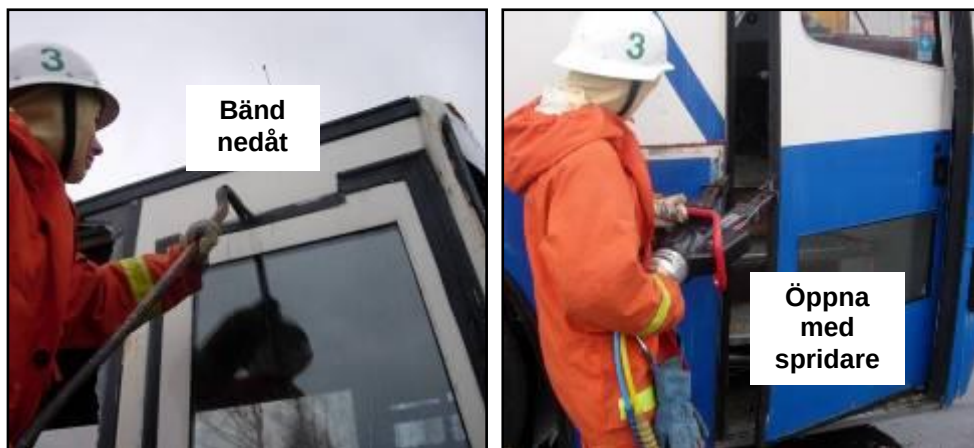
Figur 7.5. En busstdörr på en turistbuss forceras lämpligen genom att först tvinga ner dörren 5–6 cm med ett bräckjärn för att därefter med spridaren bända upp dörren från dess bakre del. Linjebussar har sällan denna konstruktion och på dem räcker det att bända upp dörren.
