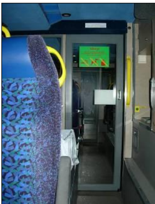
Figur 10.2. Busskrascher med dubbeldeckare ger speciella förhållanden. Bilden visar dörren mellan passagerarutrymmet och förarutrymmet i nedre planet på en dubbeldeckare. Om bussen vält och lagt sig på sidan så att dörrarna blockerats är detta i praktiken den enda evakueringsvägen för personer på nedre planet
