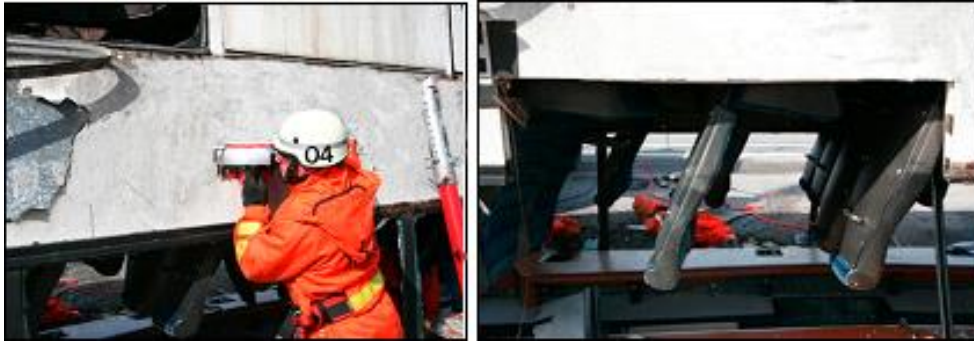
Figur 9.4. Bilden visar hur man med cirkelsåg kan ta upp luckor i bussidan. En sådan lucka kan tas upp på några minuter. En säkerhetsman och ambulanssjukvårdare kan därefter sändas in.
