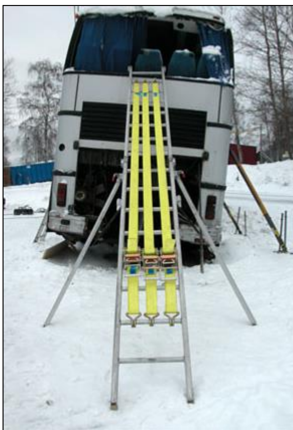
Figur 10.3. Användning av två ihopkopplade stegar vid evakuering. Stegarna spänns ihop med tre breda spännband som inte bara håller ihop stegarna, utan också ger en bra glidyta för bårar och drabbade. I detta fall visas hur uppställningen kan se ut vid evakuering genom bakrutan.
