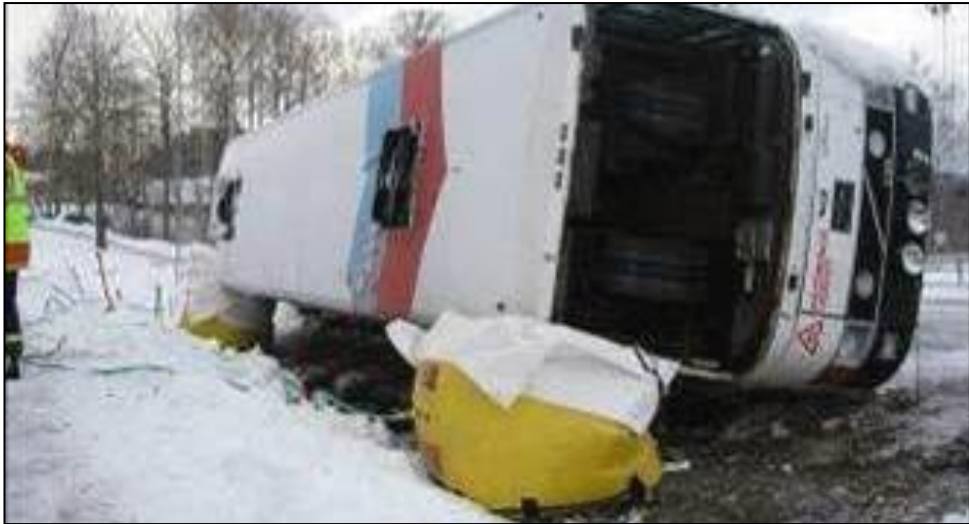
Figur 8.13. Lyft med två lyftkuddar Bilden visar hur en buss med stålkaross lyfts med hjälp av två lyftkuddar. På bilden saknas dock pallningsvirke.
