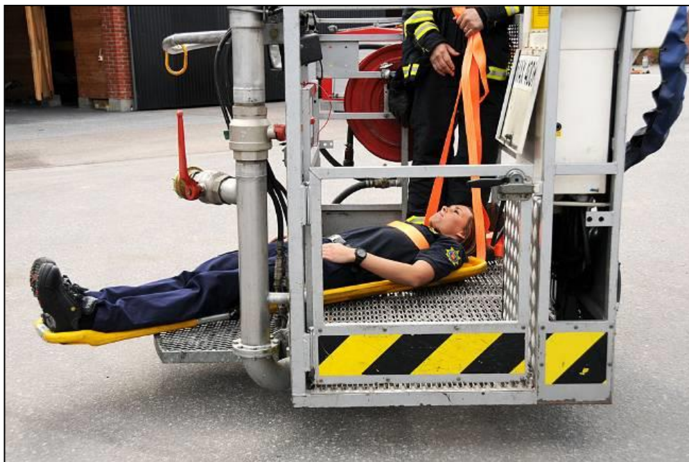
Figur 10.10. Evakuering med hävare är ett alternativ. Båren placeras lämpligen på golvet i hävaren enligt bild.
