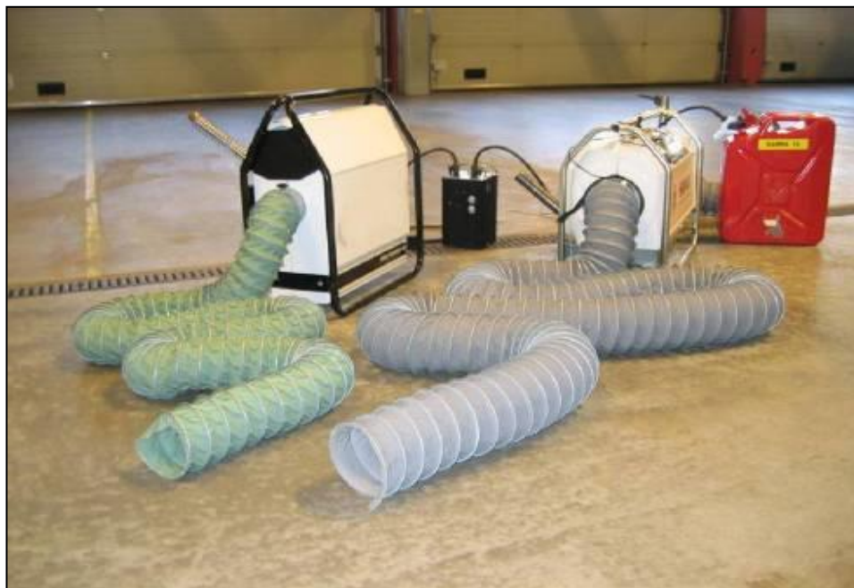
Figur 11.7. Bilden visar ett exempel på en mindre modell av portabel dieselvärmare som dock kräver strömförsörjning.
