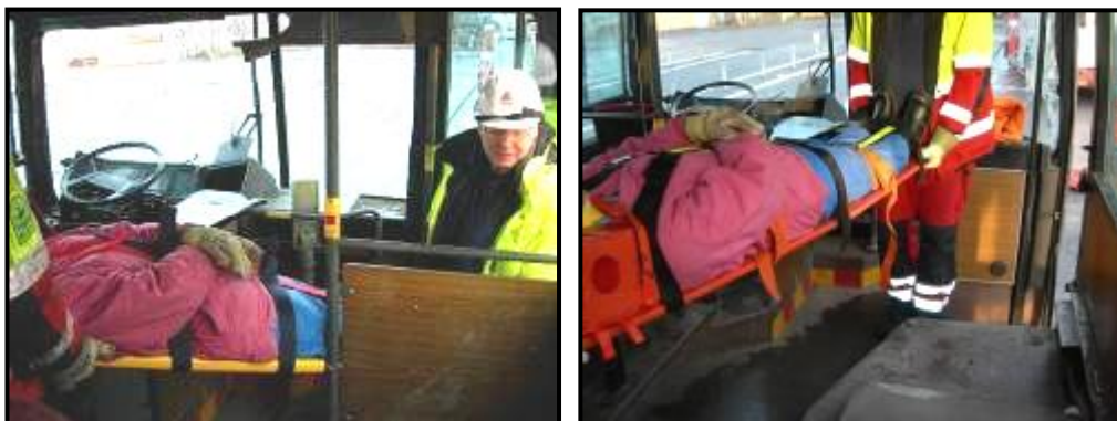
Figur 7.7. Genom att klippa bort väggen, stolpen och stolssätena vid främre utgången får personalen gott om svängrum.
