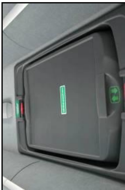
Figur 8.4. På en modern buss ska takluckorna kunna användas som nödutgång. De har ofta måtten 50 x 80 cm, men kan ibland vara något mindre. Från och med 2018 gäller enligt ECE R107-06 reglementet minimum 60x70 cm (420000mm 2 ) De kan öppnas både inifrån och utifrån. På utsidan sitter ofta ett rött handtag som man kan öppna luckan med. På insidan är det vanligt att takluckan är säkrad mot vandalism med en plomberad vajer eller någon annan typ av säkring i luckans bakkant.
