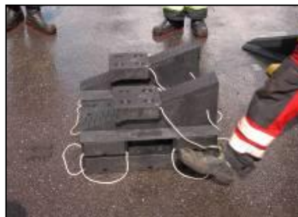
Figur 7.3. Bilden till vänster illustrerar hur stabiliseringsstöttor och kilformade block (bilden till höger) kan användas för att stabilisera en buss som står på hjulen.
