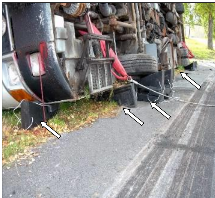
Figur 8.1. Bilden visar hur de kilformade blocken bör placeras.
