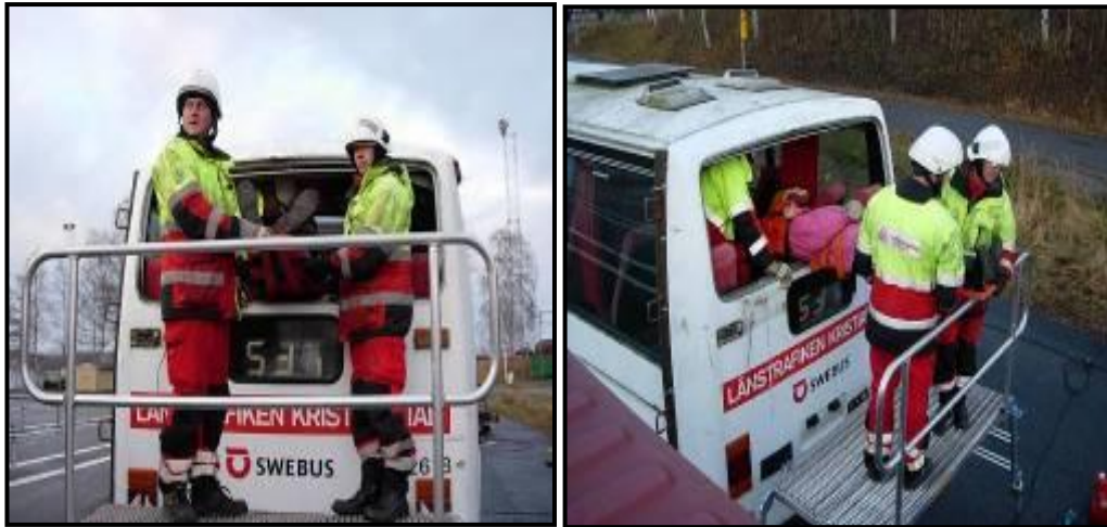
Figur 7.8. Exempel på användning av plattform vid evakuering. Det är viktigt att plattformen stabiliseras ordentligt så att dessa svåra lyft kan ske säkert. En skylift eller hävare kan vara ett alternativ.
