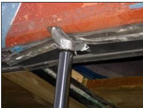
Figur 8.11. Det är en fördel att applicera lyftkraften så brett som möjligt över tak balken, särskilt vid högre lyft.
