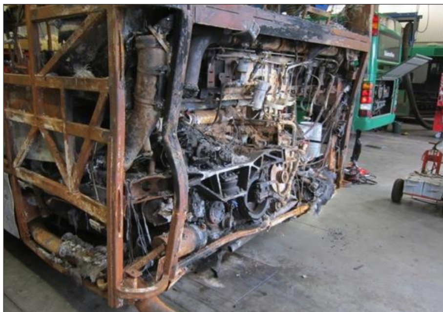
Figur 12.5. Bilden visar bakpartiet på MAN-bussen med de skador som uppstod på bl.a. behållaren för styrservoolja och på bränslefiltret (Bild ur rapport från Statens haverikommission, 2013).
