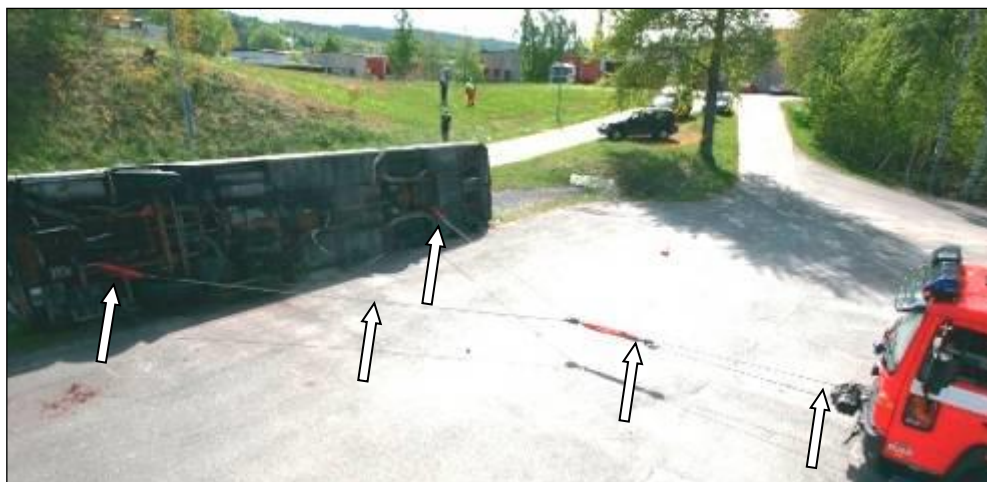
Figur 8.2. Översiktsbild som visar hur en buss på sidan kan stabiliseras med vinsch och vajer. Planera så att ambulansernas väg till närmaste sjukhus inte blockeras, dvs. ha inte vägen till sjukhuset på ena sidan om vajern och ambulansen på den andra om det inte går att ordna en lättillgänglig alternativ väg.
