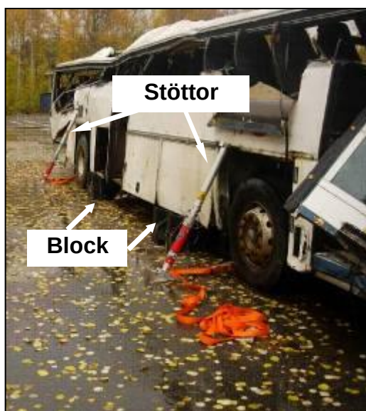
Figur 7.3. Bilden till vänster illustrerar hur stabiliseringsstöttor och kilformade block (bilden till höger) kan användas för att stabilisera en buss som står på hjulen.
