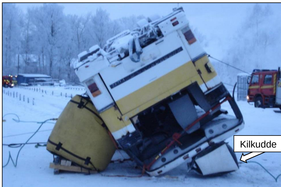
Figur 9.7. Bussen vältes med hjälp av en kilkudde och på mottagande sida tar de stora kuddarna emot. Ur dessa mottagande kuddar släpps luften sakta ut så att bussen kan rotera ner och lägga sig på sidan så att en standardevakuering av typ "buss på sidan" kan ske.
