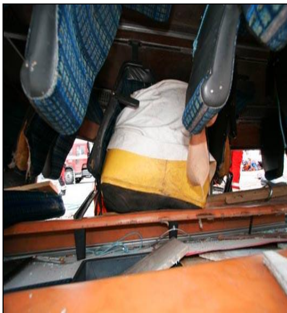
Figur 9.3. Två metoder för att öppna upp mellan tak och kaross på en buss som ligger upp och ner med intryckt tak. Övre bilden visar användning av en hydraulcylinder och den nedre visar användning av en luftkudde som klämts in på lämplig plats.
