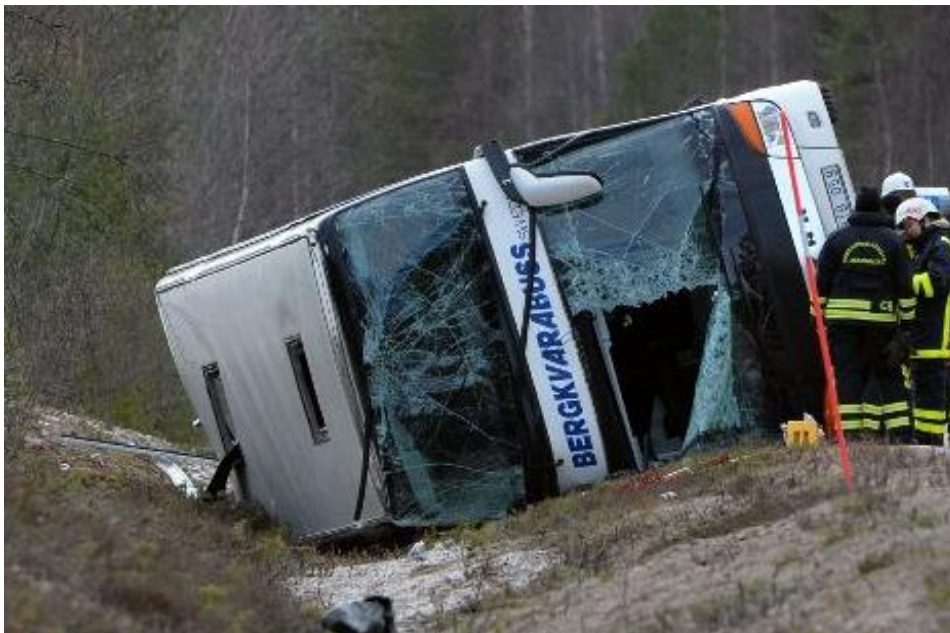
Figur 10.1. Vid busskraschen i Sveg hamnade bussen med alla dörrar nedåt. Enda vägen för att komma ut var genom fram – eller bakruta, alternativt genom en nödlucka. De omkomna (alla barn) hade samtliga klämts under bussen, efter att ha åkt ut genom krossad ruta. Dock fanns ytterligare tre åkande som kastats ut men mirakulöst inte omkommit.
