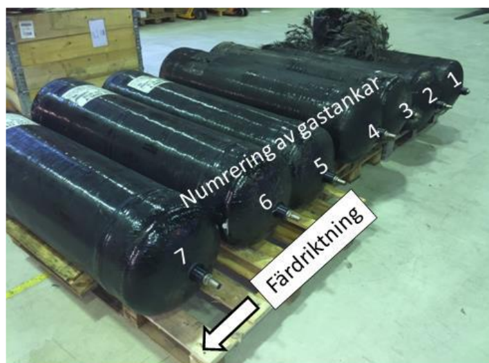
Figur 12.8. Gastankarna 1-3 exploderade och flög av busstaket. Gastankarna 7,6 och 5 är opåverkade och rena efter branden (Bild ur Hagberg et al, 2016).
