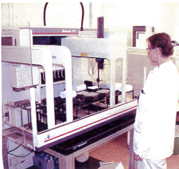
Inger Lundgren vid en lab-robot för pipettering av stora mängder prover i små volymer, 2006.
