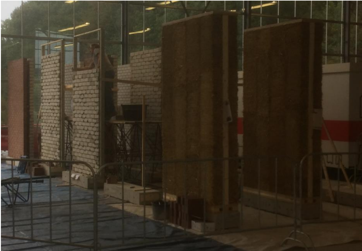
Väggsegment med växtråvara som isolering. Dessa hållfasthets testades i en intilliggande rigg.
