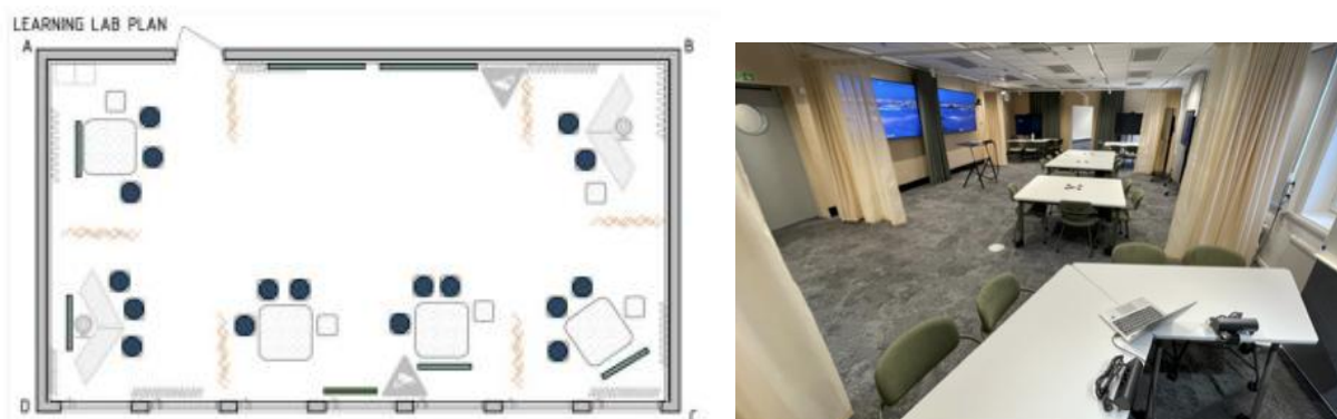
Fig. 13. Ritning samt foto av Learning Lab som visar akustikdämpande draperier mellan gruppytorna
